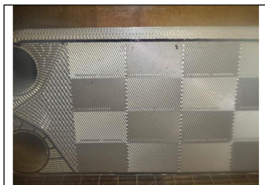
شکل ۱۱- مبدل حرارتی صفحه و قاب پس از تمیزکاری و عملیات بعدی با مواد شیمیایی بدون فسفر.
