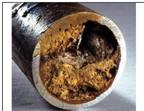
شکل ۳- لوله تقریباً مسدود شده توسط محصولات خوردگی.
