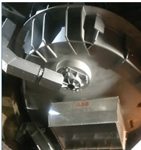
شکل ۲- کوره قوس الکتریکی با همزن ArcSave نصب شده در زیر کوره.
