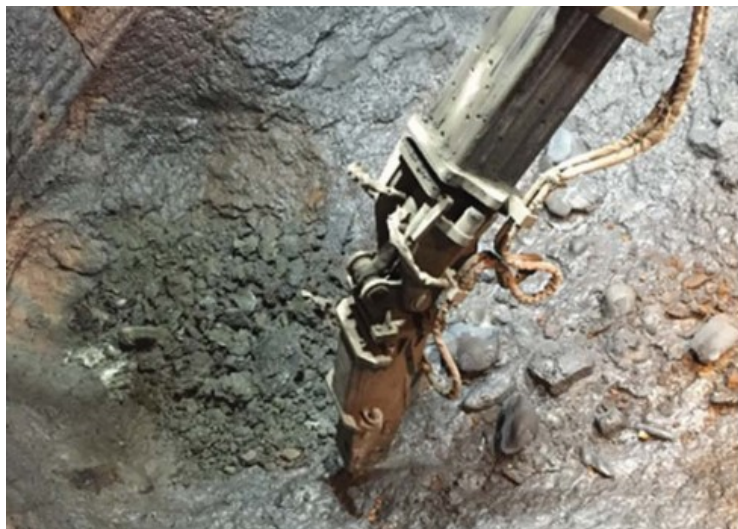
شکل ۱- عکس اسکول کف گرفته شده از کوره قوس الکتریکی کارخانه SeAH: اسکول کف و دستگاه برداشتن در محل (a) و بخشی از اسکول برداشته شده توسط جرثقیل (b).
