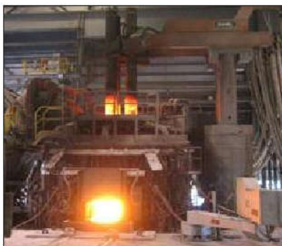
شکل 1- کوره قوس الکتریکی کارخانه جکسونویل.
