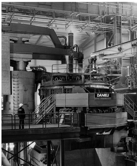
شکل 1- تکنولوژی قابل اعتماد danarc EAF دانیلی در نسل جدید کوره‌های ذوب FastArc™ تکامل یافته است.
