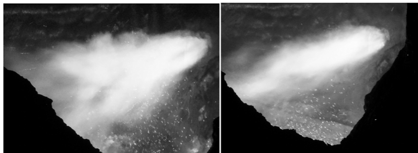
شکل 7- ویژگی‌های شعله DanHELIOS® - تبدیل از شعله بزرگ به شعله متمرکز.
