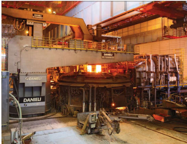
شکل 4. کوره قوس DC دو الکترودی با توان 175 MW شرکت توکیو استیل.
