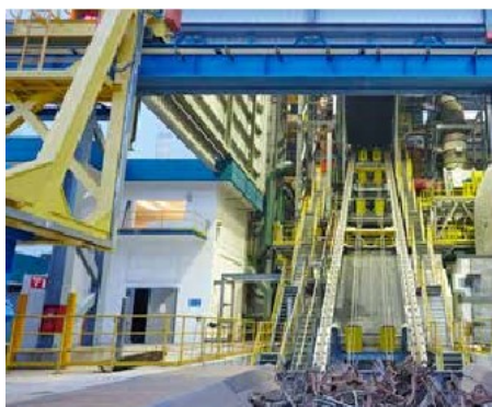
سیستم شارژ خودکار قراضه از طریق بالابر
