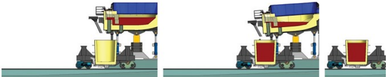
شکل ۷- a: قبل از تخلیه، b: پایان تخلیه، c: پس از تخلیه
