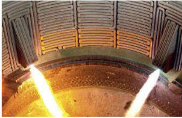
شکل 1 - انژکتورهای SIS در حال کار.
