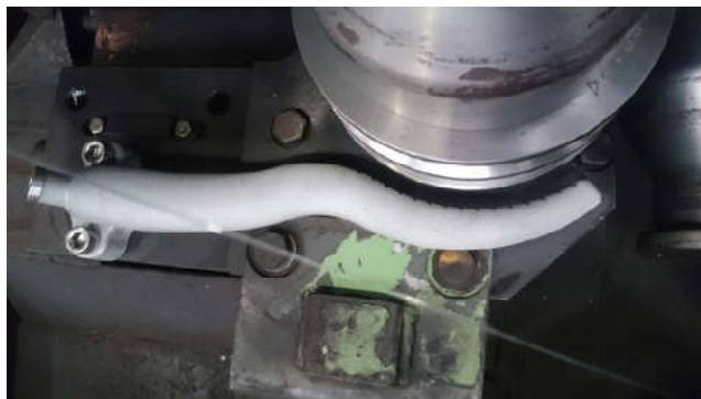
شکل 7- افشانک نصب‌شده خنک‌کاری غلتک.
