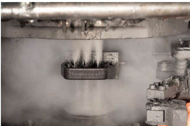
شکل 3- افشانک جدید در حال کار.
