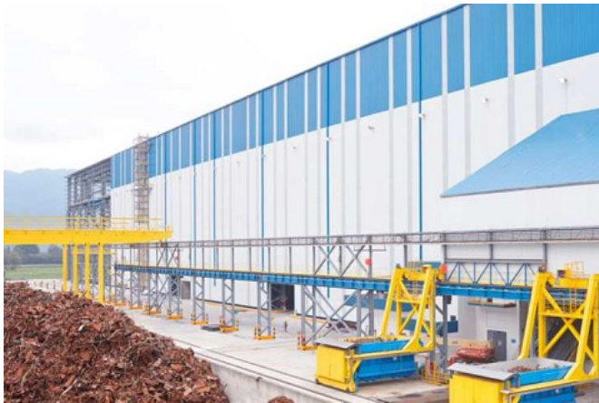
شکل ۳. بارگذاری قیف در محوطه قراضه.
