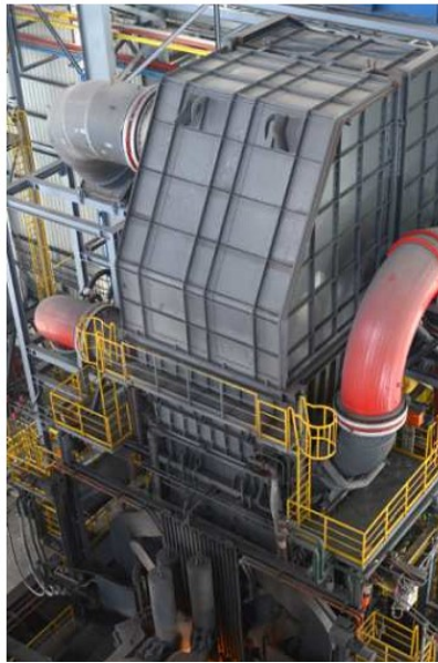
شکل ۱۵. نمای بالای EAF Quantum
