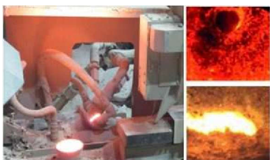
شکل 14. تجهیز پر کردن ماسه مجرای Q-EBT.
